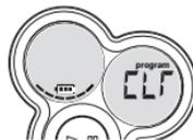
Anmerkung: Das Programm wird auch gelöscht wenn die Stromversorgung unterbrochen ist oder wenn der Deckel geöffnet wird oder wenn sich das Gerät automatisch ausschaltet.
