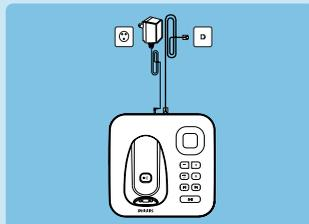
2. Netzanschluss- & Telefonkabel dann an die jeweiligen Anschlussbuchsen an der Unterseite der Basisstation anschließen.
