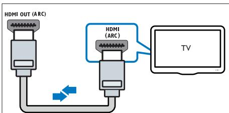
**1** Χρησιμοποιώντας ένα καλώδιο HDMI υψηλής ταχύτητας, συνδέστε την υποδοχή **HDMI OUT (ARC)-TO TV** του SoundBar με την υποδοχή **HDMI ARC** της τηλεόρασης.
