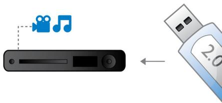
El bus serie universal o USB es un protocolo estándar para conectar ordenadores, periféricos y aparatos electrónicos de consumo. Los dispositivos USB de alta velocidad tienen una tasa de transferencia de datos de hasta 480 Mbps, a diferencia de los 12 Mbps de los USB originales. Gracias al enlace USB 2.0 de alta velocidad, todo lo que
