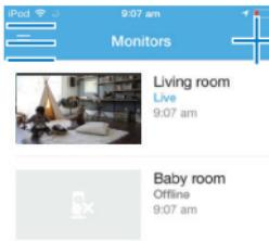
Pokud je v mobilním zařízení u monitorovacího zařízení uveden stav offline, ověřte, že síť, ke které je monitorovací zařízení připojeno, je připojena k internetu.
