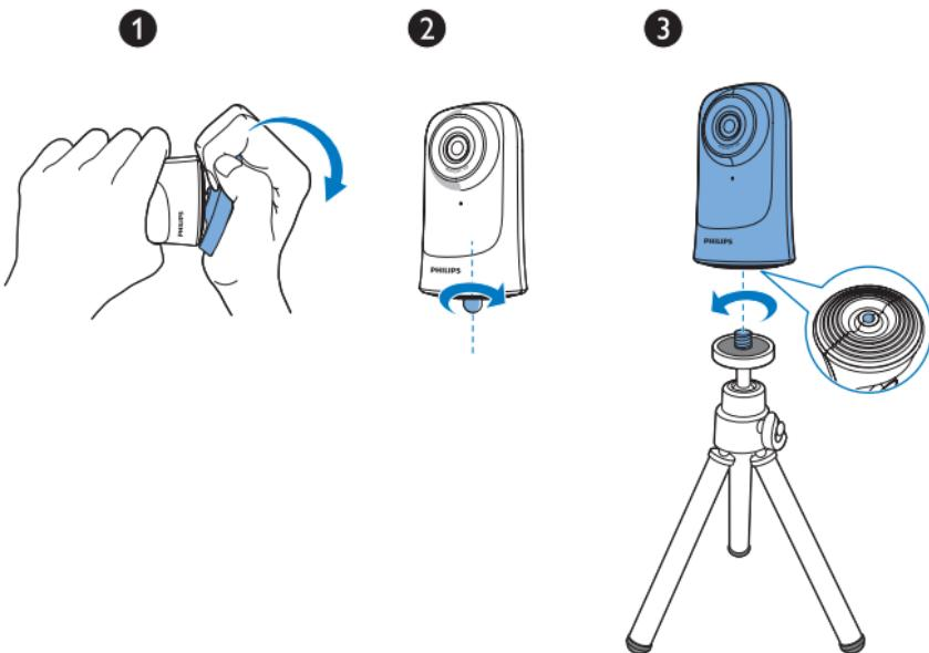
V případě potřeby můžete monitorovací zařízení upevnit na stativ (není součástí balení).
