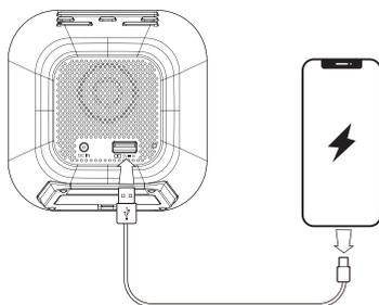
Branchez une extrémité de taille standard d'un câble USB (non fourni) dans la prise USB de l'arrière de l'unité et branchez l'autre extrémité sur la prise de charge de votre appareil.
