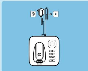
2. Conecte o cabo do telefone e plugue da fonte de alimentação nos seus conectores correspondentes na parte traseira da estação base.
