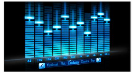
Este ecualizador paramétrico proporciona bandas de 11 frecuencias diferentes (63 Hz, 100 Hz, 160 Hz, 250 Hz, 400 Hz, 630 Hz, 1 kHz, 2 kHz, 4 kHz, 8 kHz y 16 kHz), que brindan la libertad de ajustar los graves, tonos medios y agudos para adaptarse a la acústica del automóvil. Además, el ecualizador permite guardar las configuraciones favoritas de ecualización y recuperarlas fácilmente. Con Philips, siempre disfrutarás el sonido fabuloso en el automóvil en la forma y en el momento que desees.
