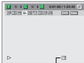
L'icône des angles apparaît si la commutation des angles de prise de vue est possible.
