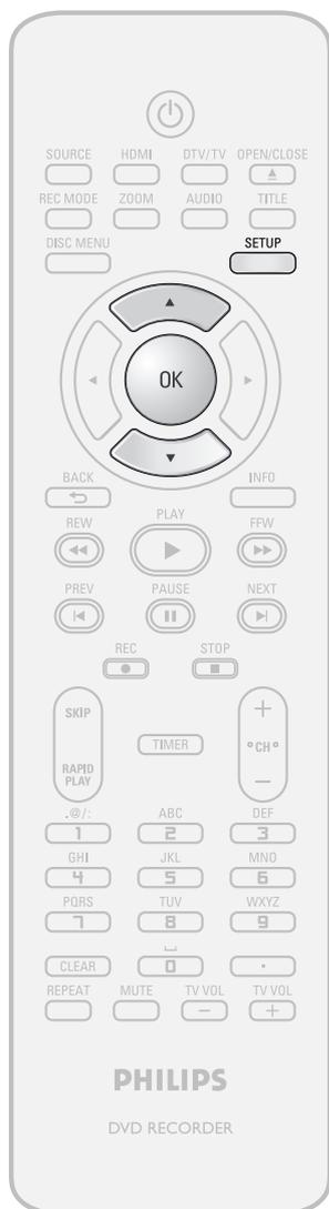
**1** Appuyez sur [SETUP] et utilisez [▲ / ▼] pour sélectionner "Réglage général", puis appuyez sur [OK].
