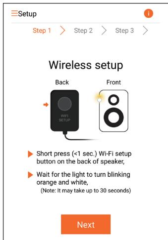
**4** Следуя указаниям, нажмите кнопку **WI-FI SETUP** на задней панели AW3000.
