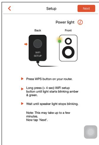
**3** Следуя указаниям, нажмите и удерживайте кнопку **WI-FI SETUP** на задней панели устройства AW3000.
