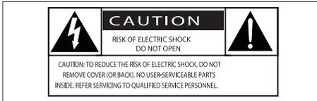
O símbolo com a forma de raio indica a existência de material não isolado no interior da unidade que pode causar choques eléctricos. Para a segurança de todas as pessoas da sua casa, não retire o revestimento do aparelho. O “ponto de exclamação” chama a atenção para funcionalidades acerca das quais deve ler atentamente a documentação fornecida para evitar problemas de funcionamento e manutenção.
