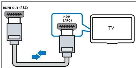
**1** Kabelem vysokorychlostního rozhraní HDMI propojte výstupní konektor **HDMI OUT (ARC)** domácího kina s konektorem **HDMI ARC** televizoru.
