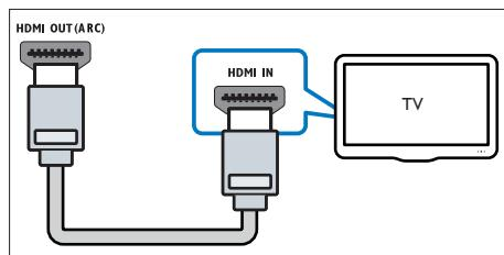
**1** Kabelem vysokorychlostního rozhraní HDMI propojte výstupní konektor **HDMI OUT (ARC)** domácího kina s konektorem **HDMI** televizoru.
