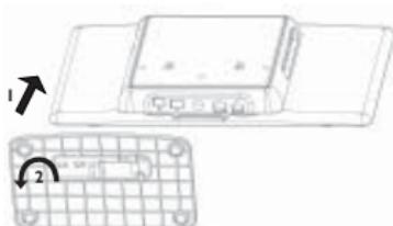
**Poznámka:** Keď TV nainštalujete na stenu (uvedzte sa na časť Upevnenie na stenu), uvoľnite stojan. Aby ste uvoľnili stojan, nadvihnite západku a otočte ju v smere hodinových ručičiek.
