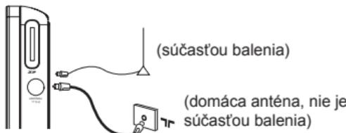
**Poznámka:** Dodávaná kábllová anténa nie je vhodná pre príjem analógového TV vysielania. Na dosiahnutie lepšieho príjmu pripojte prehrávač k domovej anténe podľa znázornenia uvedeného vyššie.
