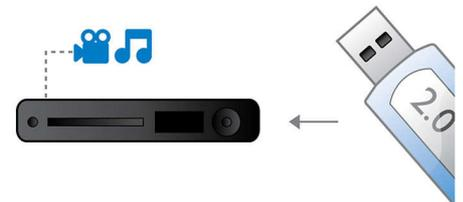
Die universelle serielle Schnittstelle, kurz USB genannt, ist ein Standardprotokoll für den problemlosen Anschluss von PCs, Peripheriegeräten und Unterhaltungselektronik. High-Speed USB-Geräte haben eine Datenübertragungsrate von bis zu 480 Mbit/s, im Gegensatz zu den 12 Mbit/s des ursprünglichen USB-Standards. Mit der High-Speed USB 2.0-Verbindung müssen Sie lediglich Ihr USB-Gerät anschließen, den Film, den Musiktitel oder das Foto auswählen und die Wiedergabe starten.
