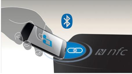
Emparelhe dispositivos Bluetooth facilmente com a tecnologia NFC (Near Field Communications, Comunicações de campo próximo) de um toque. Toque o smartphone ou tablet habilitado para NFC na área de NFC de uma caixa acústica para ligar a caixa, comece o emparelhamento via Bluetooth e inicie a transferência de músicas.
