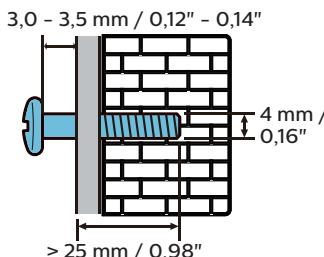
Pogledajte ilustraciju u brzom vodiču kako postaviti zvučnik SoundBar na zid.
