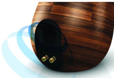
A carga acústica Bass Reflex utiliza um tubo de graves sintonizado para o volume acústico da caixa do altifalante, para reproduzir graves profundos a partir de estruturas compactas. O tubo de graves com perfil concebido cuidadosamente ajuda o ar a fluir e permite graves profundos e com impacto, mesmo a um alto volume, enquanto reduz a turbulência de ar que pode causar distorção.
