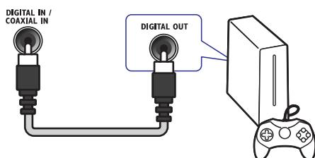
1. Izmantojot koaksiālo kabeli, savienojet **COAXIAL** ligzdu uz sava SoundBar skaļruņa ar **COAXIAL/DIGITAL OUT** ligzdu uz televizora vai citas ierīces.
