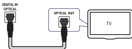
1. Izmantojot optisko kabeli, savienojet **OPTICAL** ligzdu uz sava SoundBar skaļruņa ar **OPTICAL OUT** ligzdu uz televizora vai citas ierīces.
