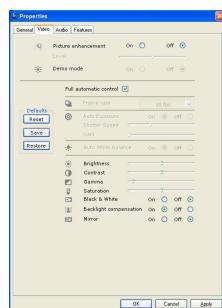
**6** Настройка значения цветовой гаммы для отображаемого изображения или видео. Настройка цветовой гаммы позволяет визуализировать больше деталей.
