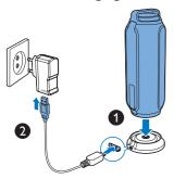
Schließen Sie den Lautsprecher mithilfe des mitgelieferten Adapters direkt an die Stromversorgung an; oder
