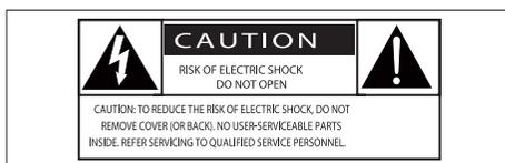
O símbolo com a forma de raio indica a existência de material não isolado no interior do dispositivo que pode causar choques eléctricos. Para a segurança de todas as pessoas da sua casa, não retire o revestimento.
