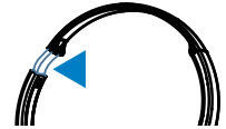
延伸臂下还提供设备的一些附加信息和序号。将耳机的延伸臂向下拉
