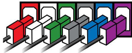
Цветово кодираните съединители за високоговорителите осигуряват просто и предразполагащо потребителя решение за свързване на високоговорителите и събуфера към централното устройство на системата чрез просто включване на съединителите в кодирания със съответния им цвет интерфейс на гърба на централното устройство.
