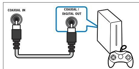
**1** Коаксиалды кабельді пайдаланып үй кинотеатрындағы **COAXIAL IN** қосқышын теледидардағы немесе басқа құрылғыдағы **COAXIAL/DIGITAL OUT** қосқышына жалғаңыз.
