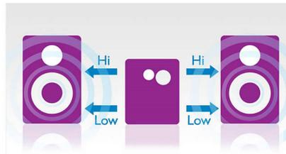
El amplificador doble optimiza el rendimiento del sonido: reduce la intermodulación entre el woofer y el tweeter porque cada transductor está controlado por su propio amplificador. Como resultado, los sonidos graves son más profundos y potentes. Además, generan interferencias mínimas con las frecuencias más
