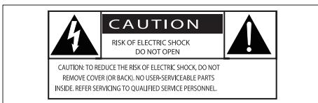
위의 '번개' 표시는 장치 내의 미절연 소자로 인해 감전의 위험이 있음을 나타냅니다. 가족의 안전을 위해 덮개를 열지 마십시오.
