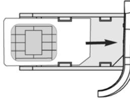
3. Insérez le tiroir de carte SIM dans son emplacement sur la base et poussez jusqu'à le verrouiller à sa place.
