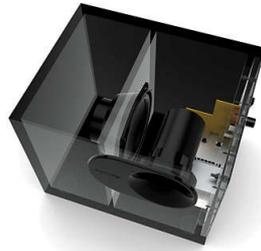
Con su diseño de una caja dentro de otra, este subwoofer con paso de banda dispone de dos cámaras de volumen para crear más capacidad de aire y ofrecer un sonido grave general de mejor calidad, con un mejor equilibrio y menos distorsión. La energía de audio del controlador central se concentra de forma más eficaz en el rango de frecuencia de salida deseado, produciendo una imagen sonora general más definida y una reproducción más precisa.
