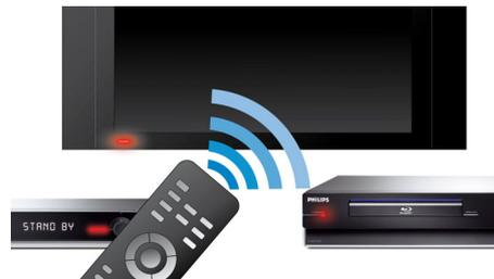
EasyLink consente di controllare più dispositivi come lettori DVD, Blu-ray, TV, ecc. con un unico telecomando. Utilizza il protocollo standard del settore HDMI CEC per condividere funzionalità tra vari dispositivi attraverso il cavo HDMI. Con un solo comando, puoi far funzionare contemporaneamente tutte le apparecchiature compatibili con HDMI CEC. Funzioni come lo standby e la riproduzione possono essere controllate in tutta semplicità.
