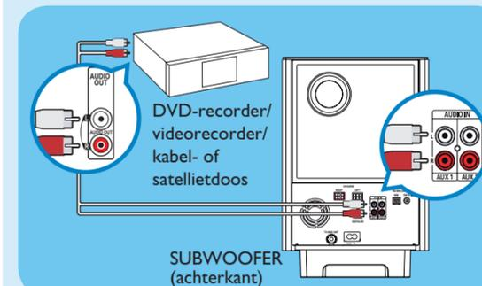
**Opmerking:** druk op **AUX/DI** op de afstandsbediening om 'AUX1' en 'AUX2' te selecteren als weergavebron.
