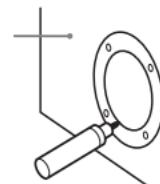
**5** 切除标记部分，并钻开螺栓孔。
