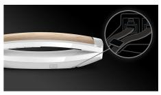
Le système de rangement du câble masque astucieusement les fils. Les prises intelligemment dissimulées et le guide-câble interne limitent l'encombrement au minimum, pour une installation discrète.
