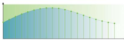
Un échantillonnage à 192 kHz permet d'obtenir une représentation précise des courbes sonores d'origine. Outre une
