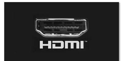
HDMI es una conexión digital directa que puede transportar vídeo digital de alta definición y audio multicanal digital. Al no convertir la información a formato analógico, proporciona una calidad de imagen y sonido perfecta, completamente libre de ruidos. HDMI es totalmente compatible con DVI.
