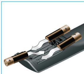
Insérez les 3 piles dans le compartiment prévu à cet effet.
