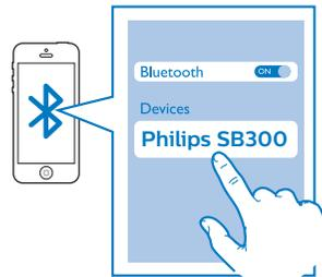
↳ Después de que el emparejamiento y la conexión se realicen correctamente, el altavoz emite dos pitidos y el indicador LED Bluetooth se ilumina en azul de forma permanente.
