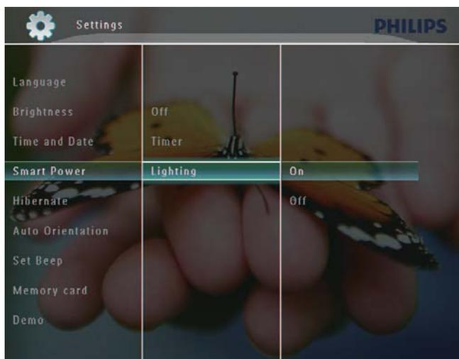
4 Για να ρυθμίσετε τη φωτεινότητα σε λειτουργία αυτόματης ενεργοποίησης, επιλέξτε **[On]** και πατήστε **OK** για επιβεβαίωση.
