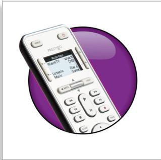
Die Fernbedienung verfügt über ein 3,8 cm (96 x 64 Pixel) LCD-Display. Über dieses Display stehen seltener verwendete Tasten zur Verfügung, sodass Sie auch zusätzliche Tasten hinzufügen oder solche, die Sie nicht benötigen, löschen können.
