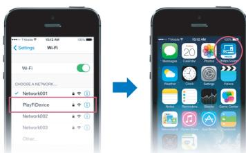
بعد اتصال شبكة Wi-Fi بنجاح، سيتوقف مؤشر Wi-Fi الموجود على الحجيرة الأمامية عن الويبس ويبصح ثابتاً. بمجرد إعداد هذا المنتج على شبكة Wi-Fi، يمكنك التحكم فيه من أي هاتف ذكي أو جهاز لوحي على نفس الشبكة.
