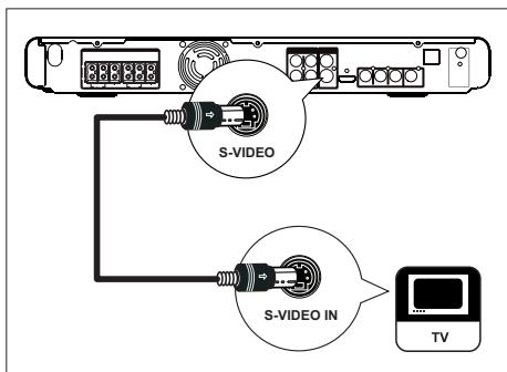
**1** Sambungkan kabel S-video (tidak dibekalkan) dari soket **VIDEO OUT-S-VIDEO** pada unit ini ke soket input S-Video pada TV anda.
