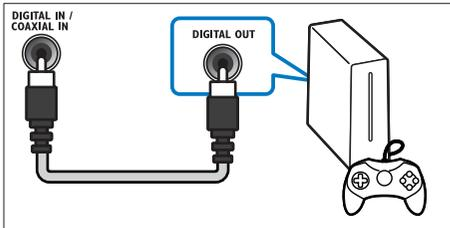
1 За допомогою коаксіального кабелю з'єднайте роз'єм **COAXIAL** на системі домашнього кінотеатру з роз'ємом **COAXIAL/DIGITAL OUT** на телевізорі або іншому пристрої.
