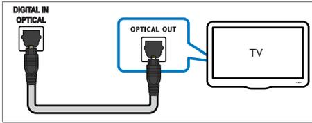
1 За допомогою оптичного кабелю з'єднайте роз'єм **OPTICAL** на системі домашнього кінотеатру з роз'ємом **OPTICAL OUT** на телевізорі або іншому пристрої.
