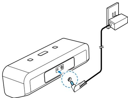
Подключите адаптер питания переменного тока: один конец — к разъему питания на задней панели устройства, а второй — к настенной электророзетке.
