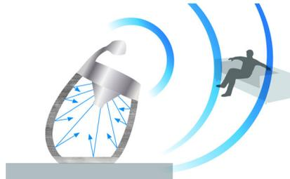
El diseño en curva especialmente cuidado de la cubierta posterior de este altavoz base de Philips crea una estructura acústica de gran efectividad para la reproducción del sonido. Su curvatura perfectamente definida refuerza la rigidez de la carcasa del altavoz, lo que reduce de forma espectacular la resonancia interna y elimina la vibración y la distorsión del sonido. De esta forma, puedes disfrutar de un sonido increíblemente nítido en unos altavoces de diseño sorprendente.
