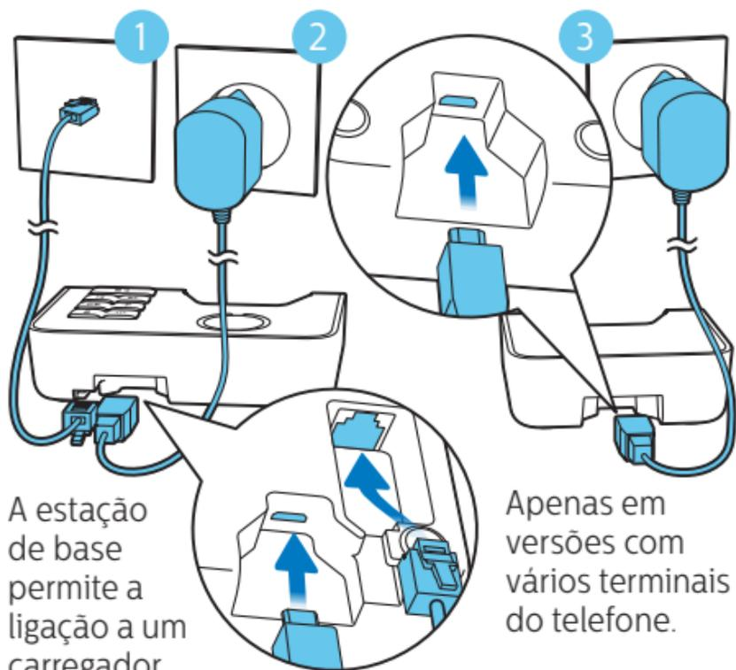
A estação de base permite a ligação a um carregador portátil como fonte de alimentação alternativa durante falhas de energia eléctrica.
