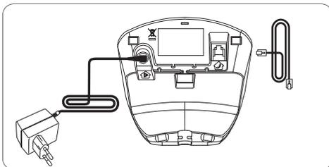
**3** Collegare l'altra estremità del cavo telefonico alla presa della linea telefonica e l'altra estremità del cavo di alimentazione alla presa di corrente.
