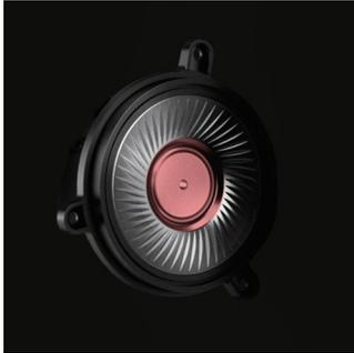
多层驱动单元震膜技术 (LMC) 驱动器具有包裹一层阻尼胶的多层聚合物隔音膜。这些层与阻尼胶一起构成灵活的边界, 吸收并抑制任何升高的频率, 形成平滑平坦的频率响应, 进而提供更均衡、自然和精细范围的高频音效。
