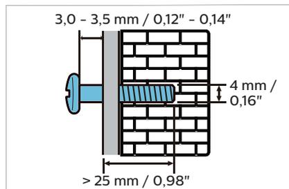
Pogledajte ilustraciju u brzom vodiču kako postaviti zvučnik SoundBar na zid.
