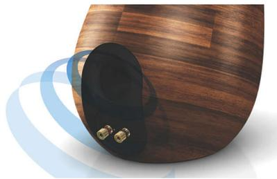
Der Akustiklautsprecher mit Bassreflex-Design nutzt eine auf das akustische Volumen der Lautsprecherbox abgestimmte Bassröhre zur Wiedergabe von tiefen Bässen über das kompakte Gehäuse. Das durchdachte Profil der Bassröhre unterstützt den Luftstrom, ermöglicht einen tiefen, satten Bass selbst bei hohen Lautstärken und minimiert gleichzeitig Luftverwirbelungen, die zu einer Verzerrung führen können.
