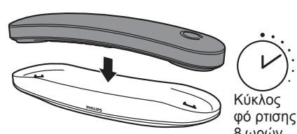
Φορτίστε τη συσκευή χειρός, τοποθετώντας τη στη βάση σε οποιαδήποτε κατεύθυνση.
