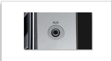
Conexión de entrada auxiliar para reproductor MP3 portátil
